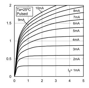
COLECTOR TO EMITTE VOLTAGE :  $V_{CE}[V]$
