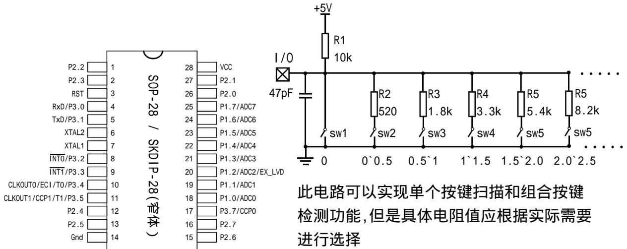
本电路图采用 10 个按键等间隔分压，每个按键正负误差余量允许在  $\pm 0.25V$  范围内变化，可以有效避免因为电阻误差或温度漂移等造成的按键检测失效，如果要求案件检测更加稳定可靠，可以减少按键数量，放宽各个按键检测电压允许误差量。
