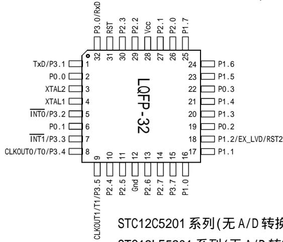
STC12C5201 系列(无 A/D 转换, 无 PWM 功能, 无内部 EEPROM), 32-Pin
