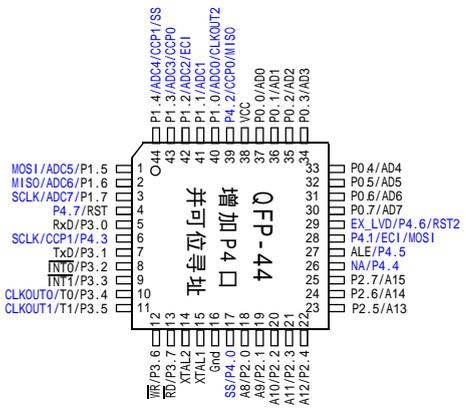
STC12C5A60AD 系列(无第二串口,有 A/D 转换,有 PWM/PCA 功能,有内部 EEPROM)
