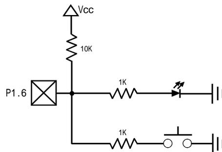
利用 STC12C5201AD 系列单片机的 I/O 口可设置成弱上拉, 强上拉(推挽)输出, 仅为输入(高阻), 开漏四种模式的特性, 可以利用 STC12C5201AD 系列单片机的 I/O 口同时作为发光二极管驱动及按键检测用, 可以大幅节省 I/O 口。
