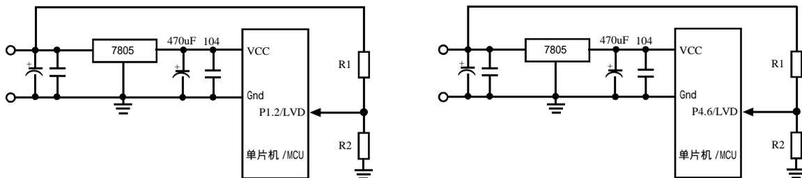
如交流电在 220V 时，稳压块 7805 前端的直流电是 11V，当交流电降到 160V 时，稳压块 7805 前端的直流电是 8.5V，图中的电阻 R1 和 R2 将 8.5V 的电压分压到低于低压检测门槛电压。此时 CPU 可以用查询方式查询，推荐使用中断，在中断服务程序里面，将 LVDF 位清零，再读 LVDF 位。如果为 0，则认为是电源抖动，如果为 1，则认为电源掉电，立即进行保存现场数据的工作。保存现场完成后，再将 LVDF 位清零，再读 LVDF 位的值。如果为 0，则认为电源系统恢复正常，此时 CPU 可恢复正常工作，如果为 1，继续将 LVDF 位清 0，再读 LVDF 的值，用此方法，等到电源恢复正常，或电源彻底掉电，CPU 进入复位状态。
