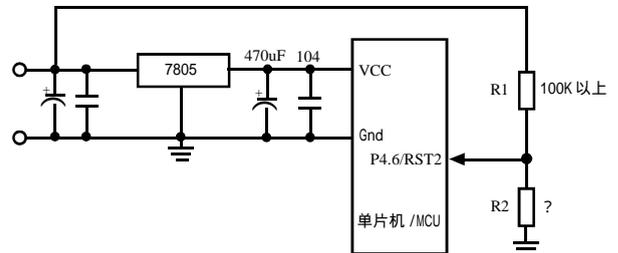
如交流电在 220V 时，稳压块 7805 前端的直流电是 11V，当交流电降到 160V 时，稳压块 7805 前端的直流电是 8.5V，上图中的电阻 R1 和 R2 将 8.5V 的电压分压到低于低压检测门槛电压(1.33V 附近)。此时第二复位功能脚 RST2 就让 CPU 处于复位状态，当稳压块 7805 前端的直流电压高于 8.5V 以上时，上图中的电阻 R1 和 R2 将 8.5V 的电压分压到高于低压检测门槛电压(1.33V 附近)，单片机就解除复位状态，恢复到正常工作状态。
