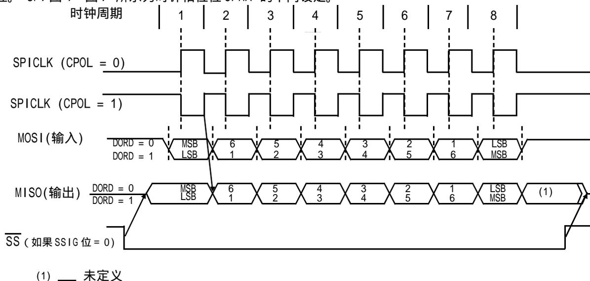
SPI 图 4 SPI 从机传输格式 (CPHA=0)
