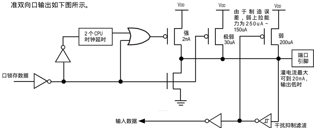
STC12LE5201AD系列单片机为3V器件，如果用户在引脚加上5V电压，将会有电流从引脚流向VDD，这样导致额外的功率消耗。因此，建议不要在准双向口模式中向3V单片机引脚施加5V电压，如使用的话，要加限流电阻，或用二极管做输入隔离，或用三极管做输出隔离。
