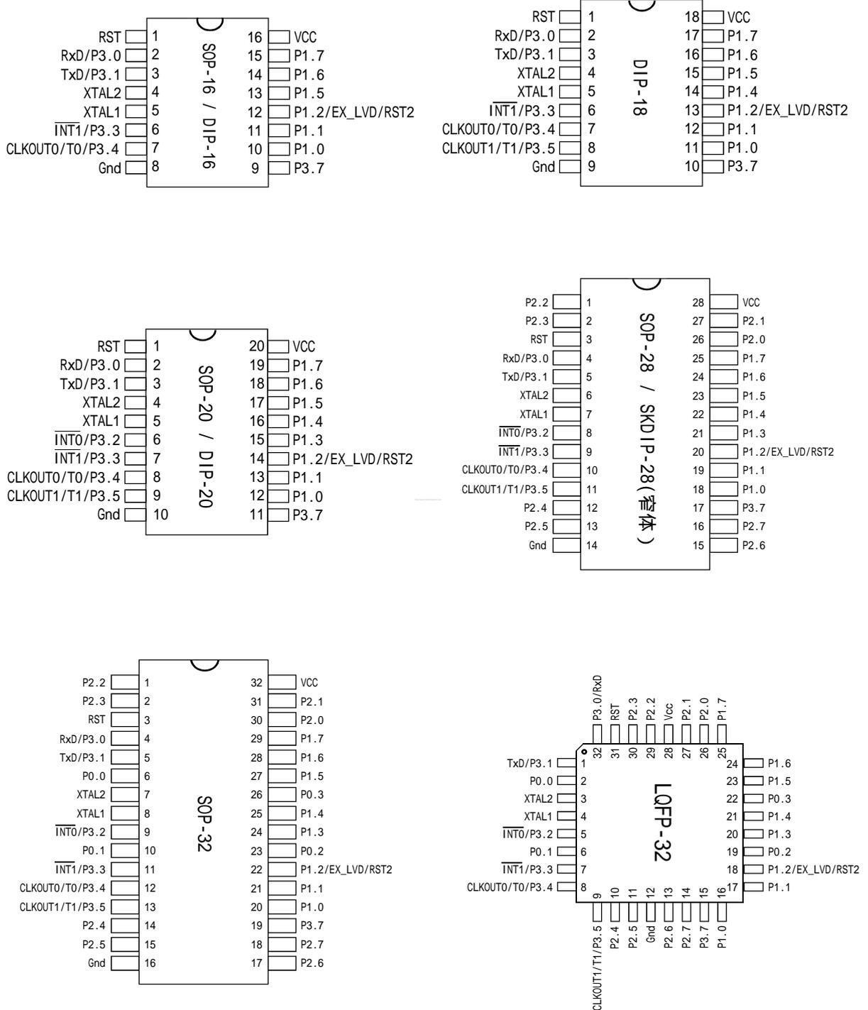
STC12C5202 系列(无 A/D 转换, 无 PWM 功能, 无内部 EEPROM)
