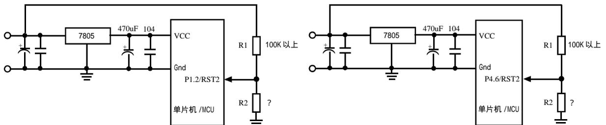
如交流电在 220V 时，稳压块 7805 前端的直流电是 11V，当交流电降到 160V 时，稳压块 7805 前端的直流电是 8.5V，上图中的电阻 R1 和 R2 将 8.5V 的电压分压到低于低压检测门槛电压 (1.33V 附近)。此时第二复位功能脚 RST2 就让 CPU 处于复位状态，当稳压块 7805 前端的直流电压高于 8.5V 以上时，上图中的电阻 R1 和 R2 将 8.5V 的电压分压到高于低压检测门槛电压 (1.33V 附近)，单片机就解除复位状态，恢复到正常工作状态。
