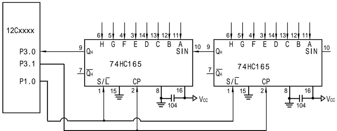
74HC165 是 8 位并行置入移位寄存器。当移位 / 置入端 ( $\overline{S/L}$ ) 由高到低跳变时, 并行输入端的数据置入寄存器; 当  $\overline{S/L}=1$ , 且时钟禁止端 (第 15 脚) 为低电平时, 允许时钟输入, 这时在时钟脉冲的作用下, 数据将由  $Q_A$  到  $Q_H$  方向移位。
