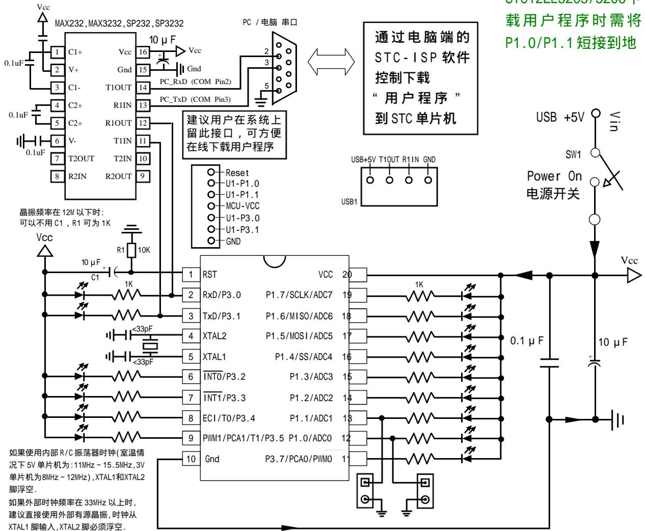
STC12C5201AD 系列单片机具有在系统可编程 (ISP) 特性, ISP 的好处是: 省去购买通用编程器, 单片机在用户系统上即可下载 / 烧录用户程序, 而无须将单片机从已生产好的产品上拆下, 再用通用编程器将程序代码烧录进单片机内部。有些程序尚未定型的产品可以一边生产, 一边完善, 加快了产品进入市场的速度, 减小了新产品由于软件缺陷带来的风险。由于可以在用户的目标系统上将程序直接下载进单片机看运行结果对错, 故无须仿真器。
