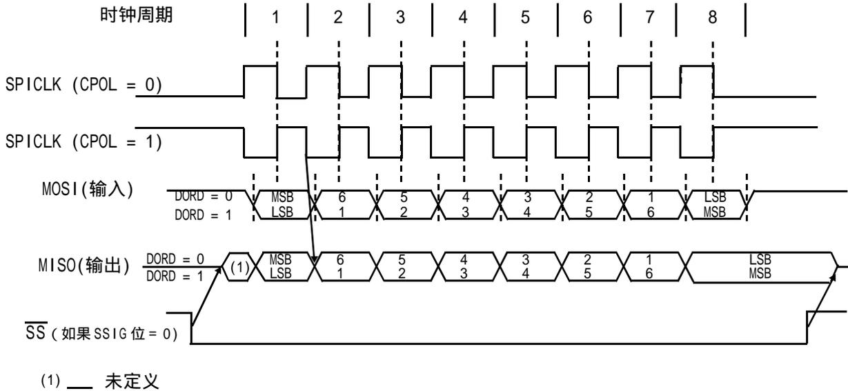
SPI 图5 SPI 从机传输格式 (CPHA=1)
