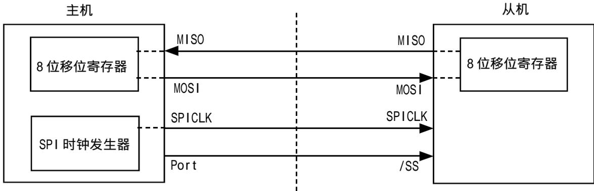
SPI 图1 SPI 单主机 - 单从机 配置
