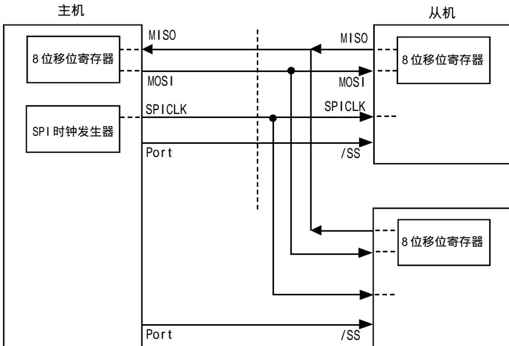
SPI 图3 SPI 单主机 - 多从机 配置
