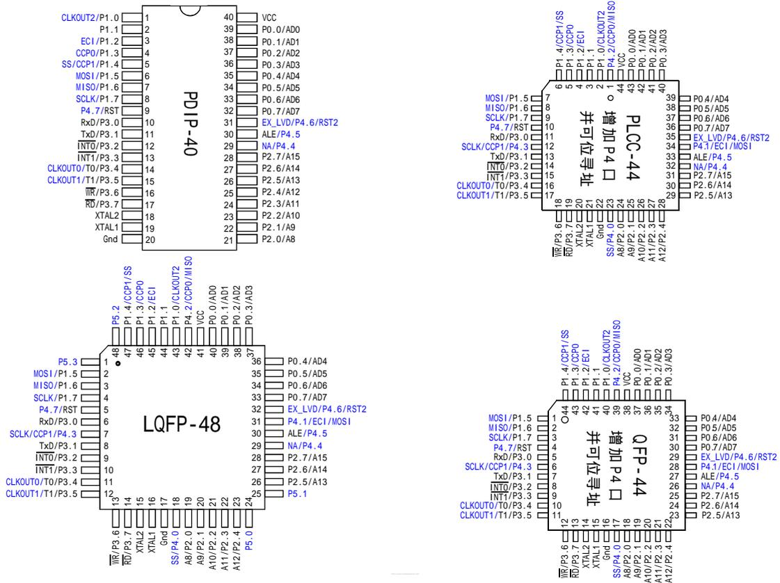
STC12C5A60PWM 系列(无第二串口,无 A/D 转换,有 PWM/PCA 功能,有内部 EEPROM)
