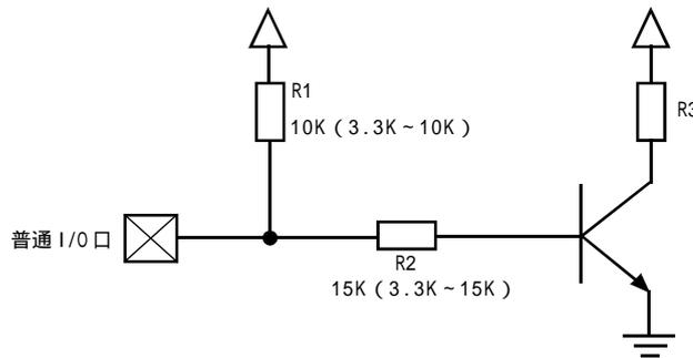
如果用弱上拉控制, 建议加上拉电阻 R1 (3.3K ~ 10K), 如果不加上拉电阻 R1 (3.3K ~ 10K), 建议 R2 的值在 15K 以上, 或用强推挽输出。
