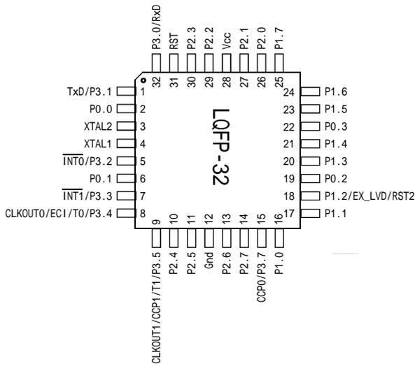
STC12C5201PWM 系列(无 A/D 转换, 有 PWM 功能, 有内部 EEPROM), 32-Pin
