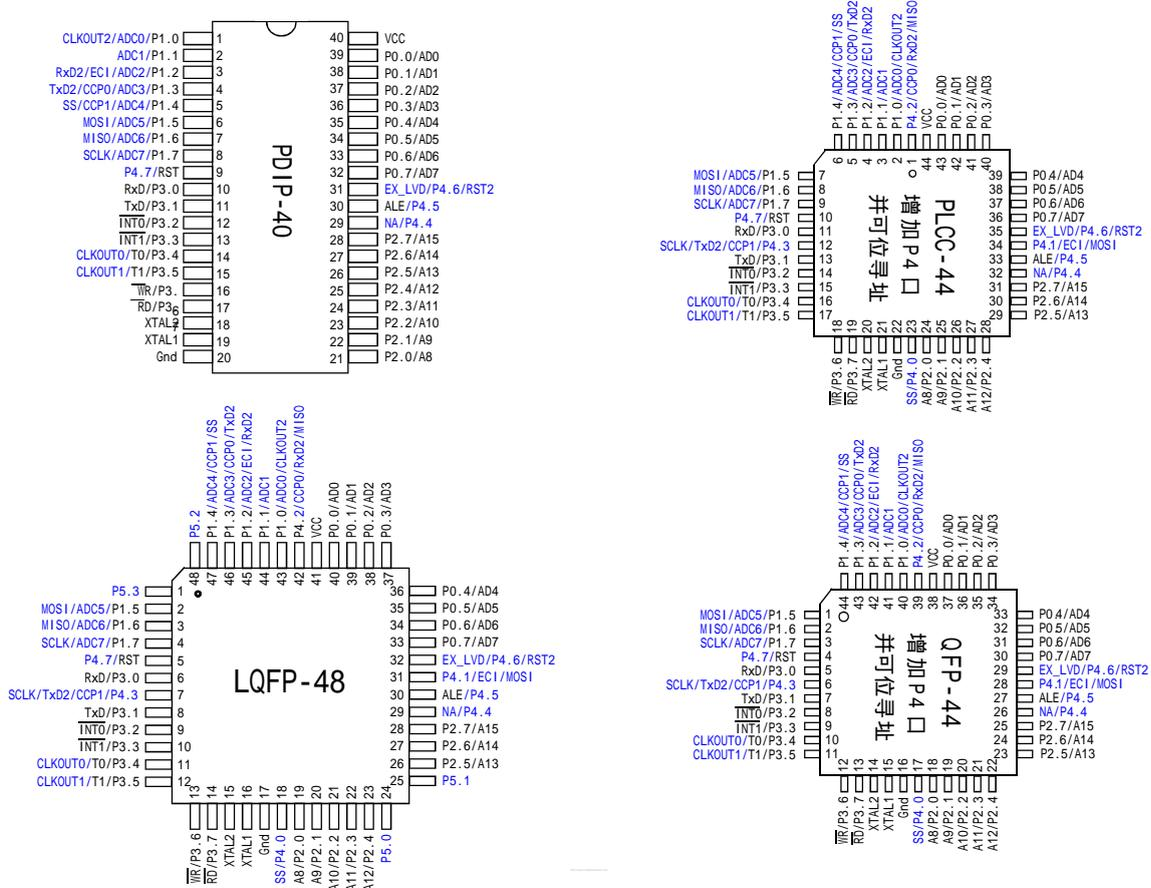
STC12C5A60S2 系列(有第二串口,有 A/D 转换,有 PWM/PCA 功能,有内部 EEPROM)
