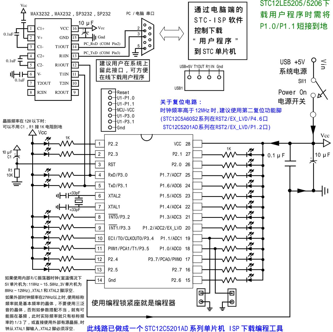
用户在自己的目标系统上, 如将 P3.0/P3.1 经过 RS-232 电平转换器转换后连接到电脑的普通 RS-232 串口, 就可以在系统编程 / 升级用户软件。建议如果用户板上无 RS-232 电平转换器, 应引出一个插座, 含 Gnd / P3.1 / P3.0 / Vcc 四个信号线, 这样就可以在用户系统上直接编程了。当然如能引出 Gnd / P3.1 / P3.0 / Vcc / P1.1 / P1.0 六个信号线为好, 因为可以通过 P1.0/P1.1 禁止 ISP 下载程序。如果能将 Gnd / P3.1 / P3.0 / Vcc / P1.1 / P1.0 / Reset 七个信号线引出就更好了, 这样可以很方便的使用“脱机下载板(无需电脑)”。
