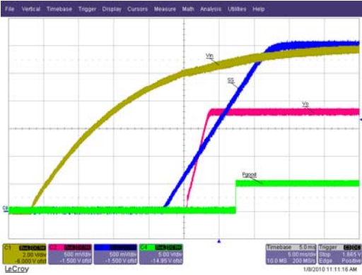
Fig. 8. Start up at 3A Load, Ch 1 : V_{in} , Ch 2 : V_o , Ch 3 : V_{ss} , Ch 4 : V_{PGood}
