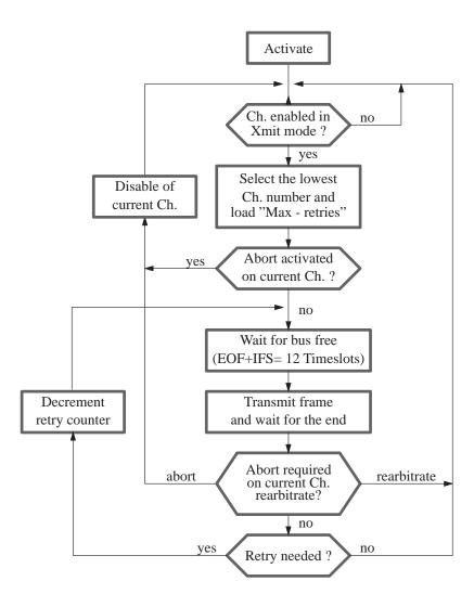
Figure 25. Transmit function
