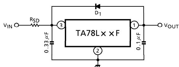
D<sub>1</sub> : IC protective diode
